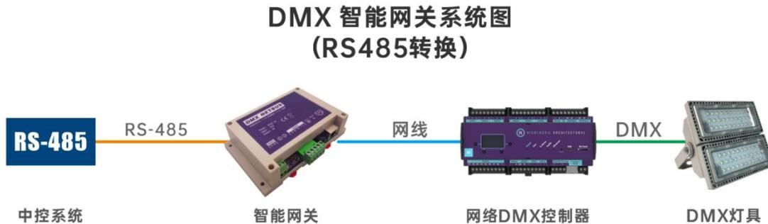
RS485 端口参数：波特率 9600，无校验，数据位 8，停止位 1
